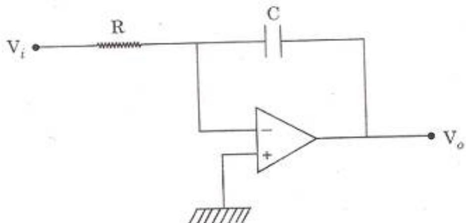
यदि  $V_i$ , 0 V और +5 V लोड वाली एक सोपान वोल्टता है, तो निर्गम वोल्टता की परिवर्तन दर क्या है ?
